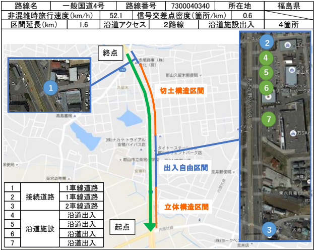
図-13 DID50km/h達成区間の確認 (福島県郡山市内)
